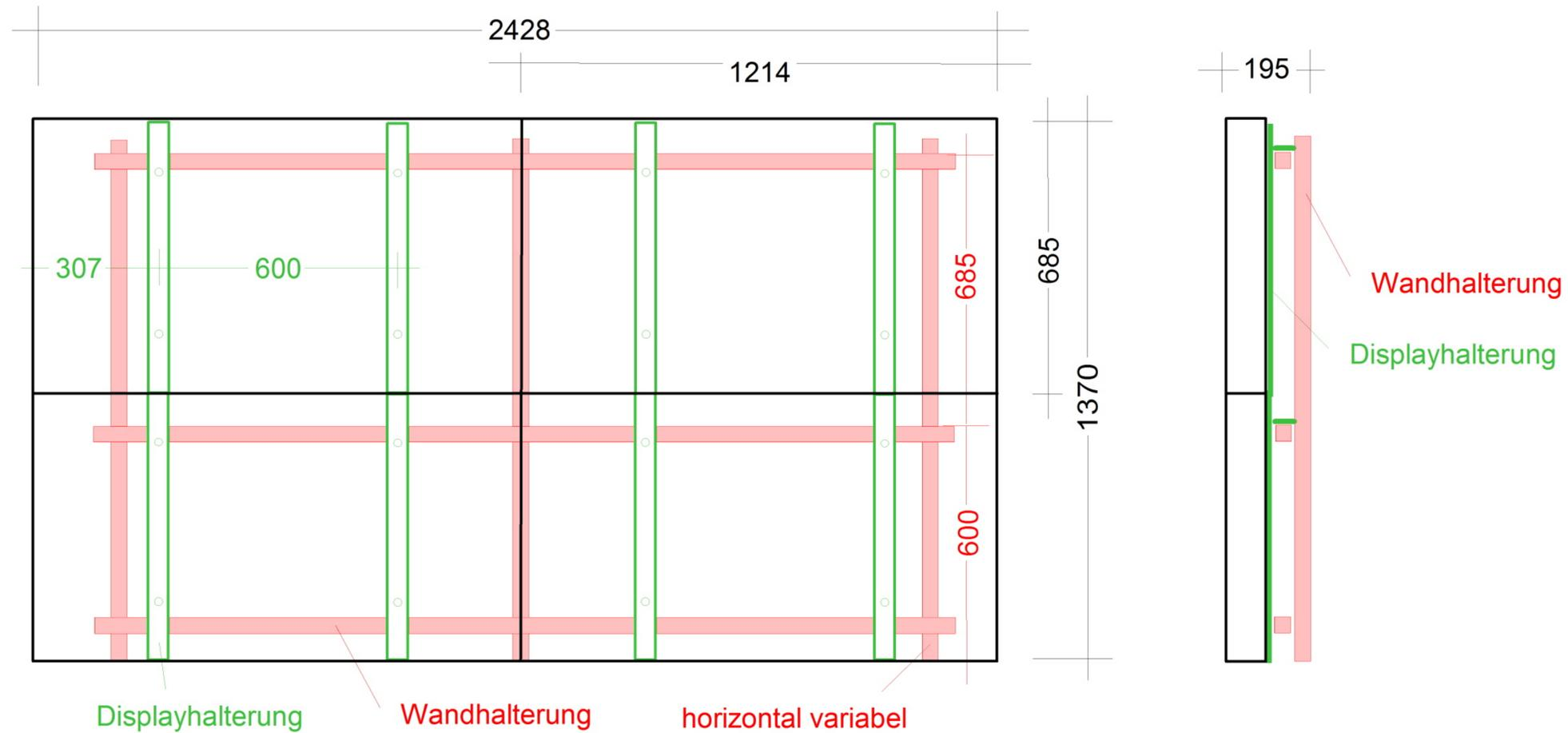
Einbaumass: 2448 x 1390 mm (=10mm Spalt ringsum)    Einbautiefe: 190mm    Gesamtgewicht: 140kg    Lüftungsöffnungen in der Rückwand am Boden und Decke
